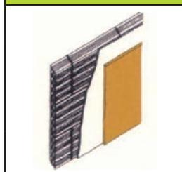
POTERE FONOISOLANTE STRUTTURA DI BASE:  $R_w=42 \text{ dB}$
